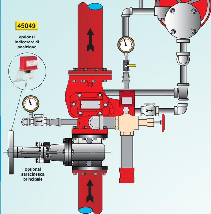
Come suggerisce il nome la valvola a diluvio detta anche "DELUGE SYSTEM" scarica una grande quantità di acqua dagli ugelli nebulizzatori, o spray. Gli ugelli sono collegati ad una tubazione opportunamente calcolata e tutti insieme scaricano l'acqua quando la valvola a diluvio si apre con il consenso di una rete di rivelazione o con comando manuale.
